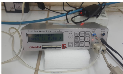
شکل 5. ست آپ آزمایشگاهی شمارش ذرات
